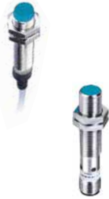
Çalışma Gerilimi 10-30 VDC, Pirinç - Nikel Kaplamalı Aşırı Yük Kısa Devre ve Ters Polarite Korumalı -25-+70C Çalışma Sıcaklığı IP67 Koruma Sınıfı Yük Akımı 100mA
